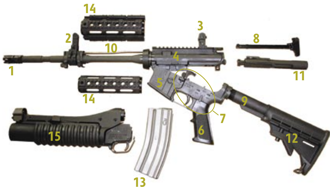
5,56mm karabina M4 A3 rozebraná k čištění
