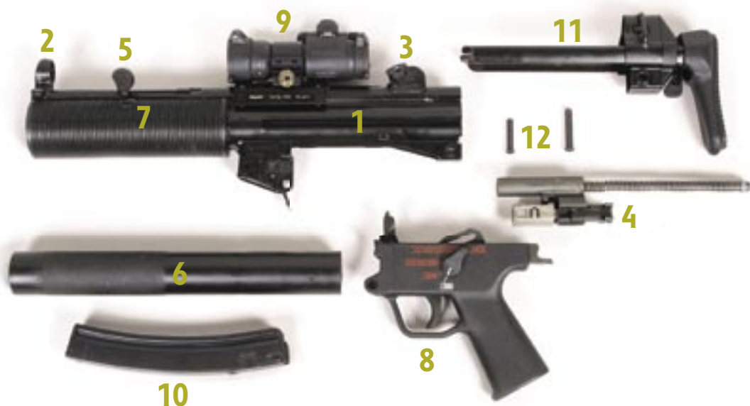
9mm samopal HK MP-5 SD 6 rozebraný k čištění
